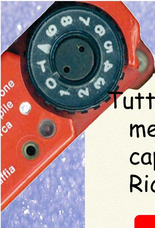
Tutto il gruppo in fila e tenendo distanza mette l'ARTVA in Trasmissione e il capogruppo sfila tenendo l'ARTVA in Ricezione...
